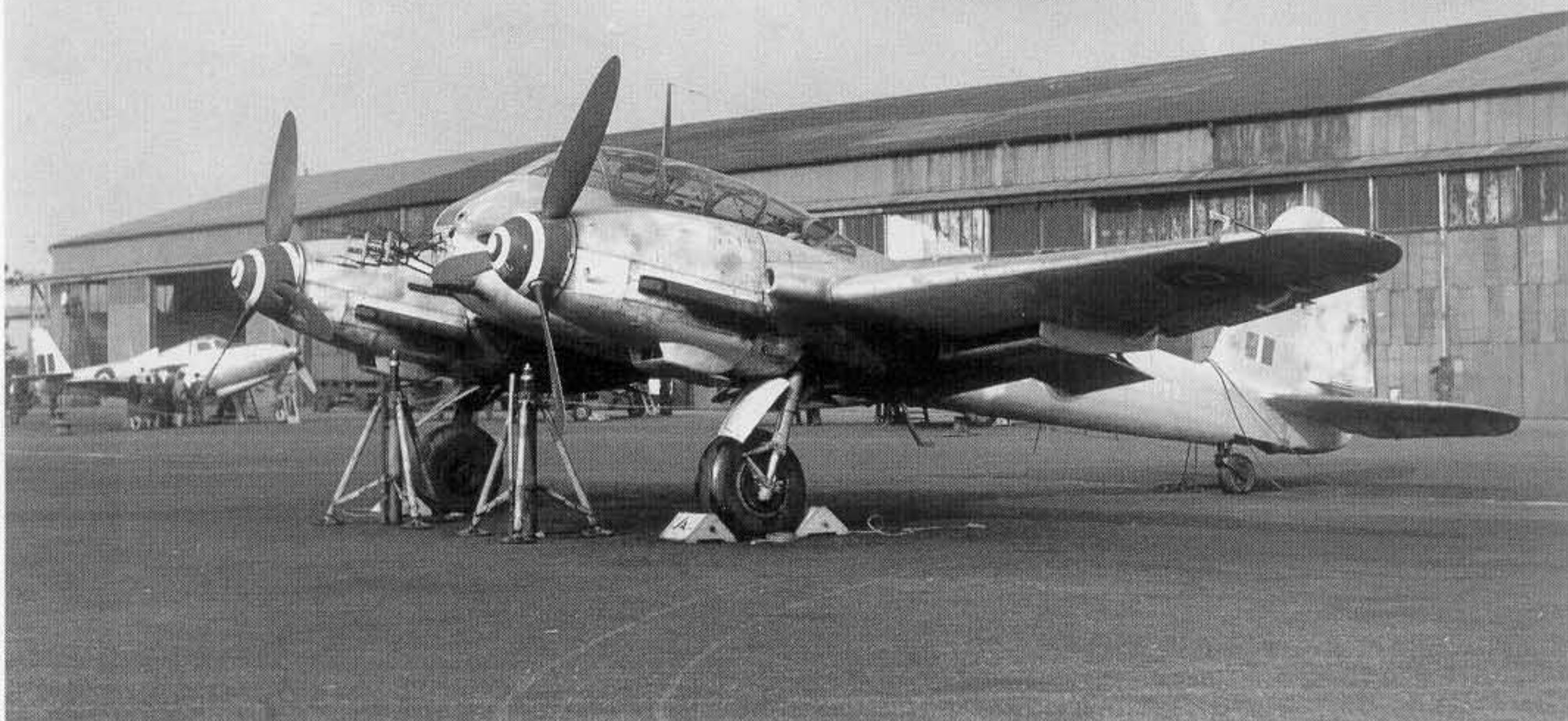
Samolot Messerschmitt Me 410B-6 posiadał radar morski typu FuG 200 „Hohentwiel” i wzmocnione uzbrojenie. Samoloty były używane przez I./ZG 1 stacjonującą we Francji do osłony własnych samolotów bombowych i rozpoznawczych operujących nad Atlantykiem. Messerschmitt Me 410B-6 of the I./ZG 1 fitted with FuG 200 "Hohentwiel" naval radar [IWM MH4893]
