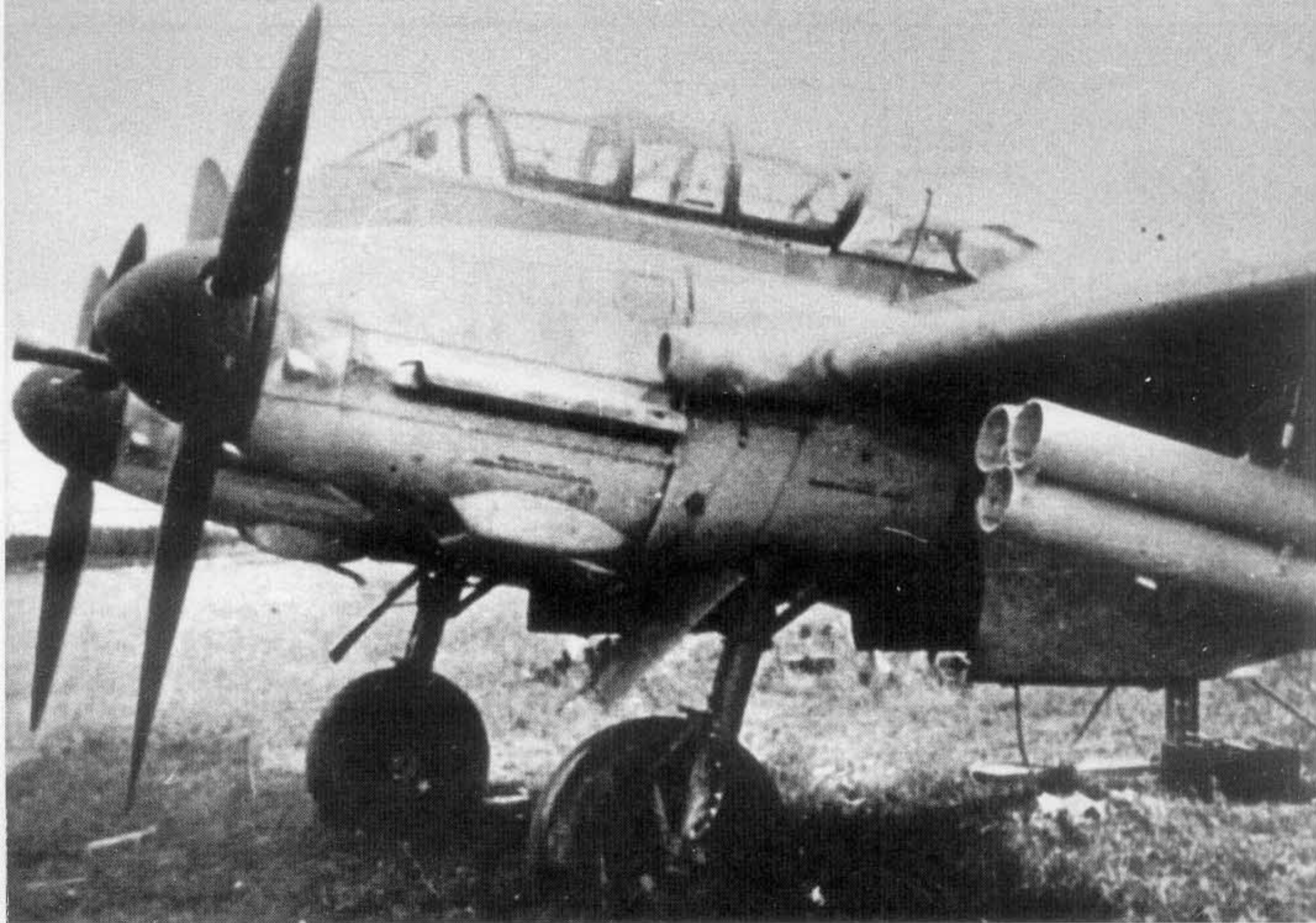
Węgierski samolot Me 210 Ca-1 (Z0+03) był uzbrojony w działko 36M (39M?) kalibru 40 mm i potrójne rurowe wyrzutnie niekierowanych pocisków rakietowych kalibru Nebelwerfer 41 150 mm pod skrzydłami, był to prototyp wersji niszczycielskiej (Zestörer), planowano przebudowę 30 samolotów, lecz dokonano modyfikacji tylko czterech samolotów, Varpalota, październik 1944 roku. Me 210Ca-1 (Z0+03) armed with 36M or 39M? 40 mm AA gun and three 150 mm Nebelwerfer 41 rocket tubes under outer wing panel, Varpalota, October 1944 [dr Peter Mujzer]
